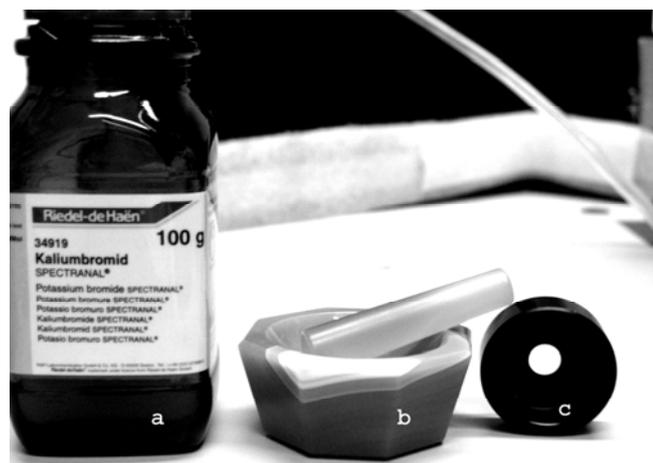
*Рис. 3.6. Бромид калия (а), агатовая ступка (b) и цилиндр для заполнения контейнера пробой при использовании приставки на диффузное отражение (с)*
